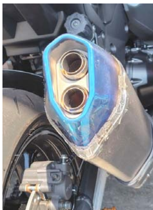
新型サイレンサー出口 (試作)
